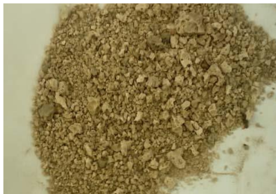
Figure 1.3 : Photo d'un échantillon de laitier granulé.
