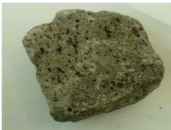
Figure 1.4 : Photo d'un échantillon de laitier cristallisé : roche.
