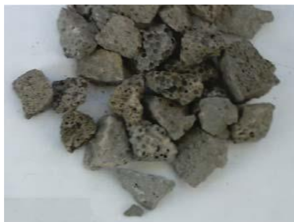
Figure 1.5 : Photo d'un échantillon de laitier cristallisé : concassé.
