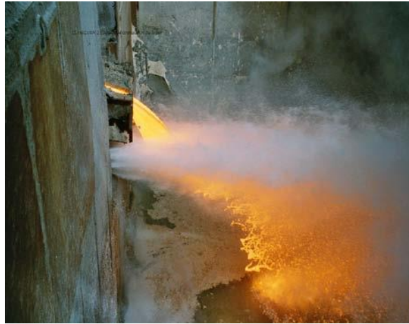
Figure I.2 - Granulation du laitier de haut fourneau d'EL HADJAR
