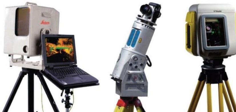
**Figure 1-4** : Trois modèles de capteurs laser, de gauche à droite : le LEICA, HDS2500, le RIEGL LMS Z90, le TRIMBLE GSX qui est une version évoluée des séries GS de la société MENSI.
