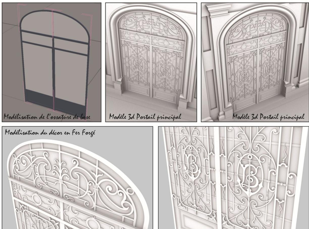
Figure 4-22 : modélisation du portail principal avec du spline renderable sous 3ds Max. (Source auteur)
