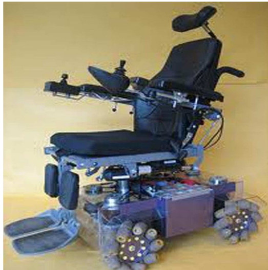
Figure 2: Fauteuil roulant omnidirectionnel proposé par Hoyer et Holper
