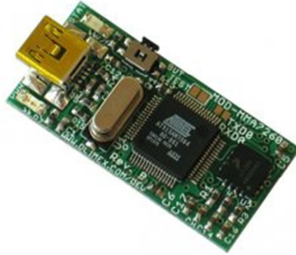
Figure 24: Carte d'accéléromètre 3 axes avec microcontrôleur AT91SAM7S64 ARM7 et interface USB et mémoire flash pour l'enregistrement
