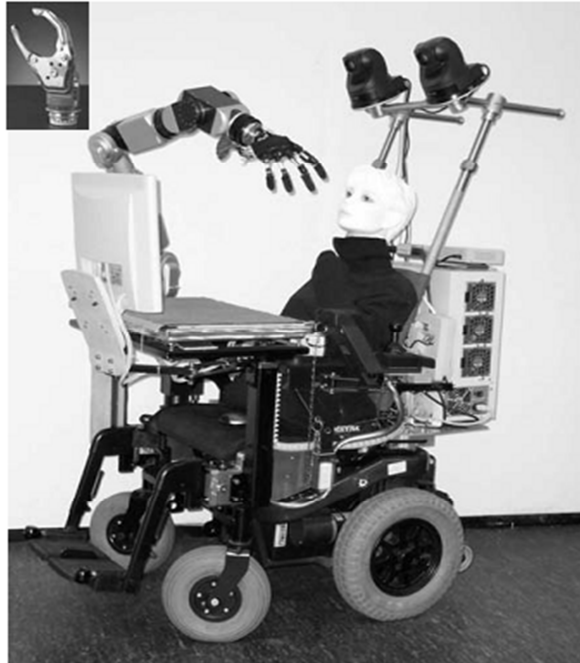
Figure 10: Le prototype FRIEND II avec bras robotisé, plateau intelligent, écran utilisateur, caméras et deux pinces disponibles.
