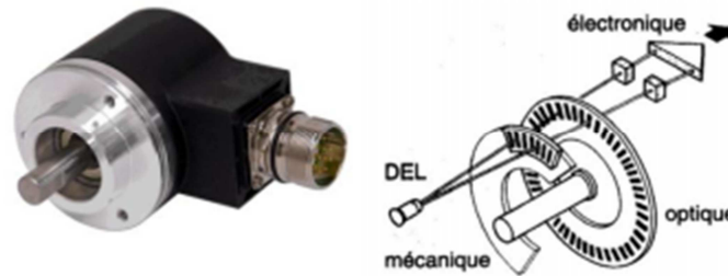
Figure 22: Exemple d'un codeur optique avec son schéma
