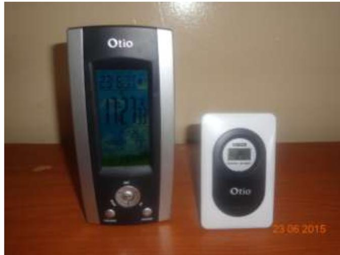
**Photo V. 5:** La centrale météo avec le capteur extérieur sans fil utilisée dans les mesures
