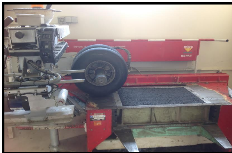
Fig.4.3 : Compacteur d'enrobé (préparation de la plaque)
