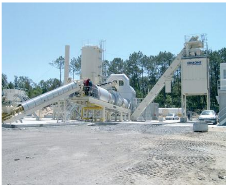
Fig.1.29 : Poste continu TSE avec anneau de recyclage
