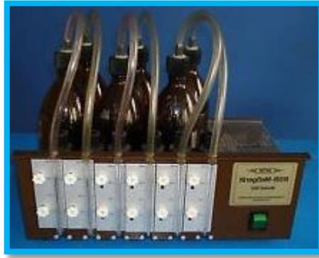
**Figure 9:** DBO meter WTW BSB Messgerät 602.
