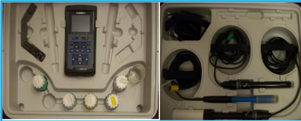
**Figure 8:** Multi-paramètres WTW Multi 3420.
