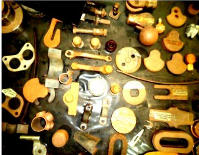
**Figure II.3 :** Exemple de pièces forgées, produites pour les véhicules ferroviaires destinés au transport des minerais et des fluides.
