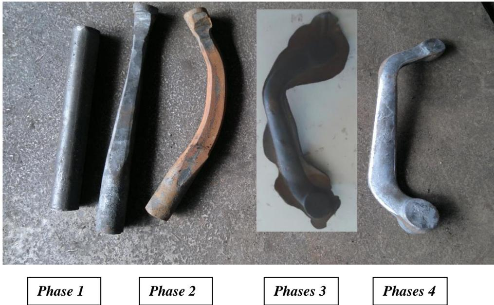
**Figure II. 6 :** Les 4 phases de mise en forme de l'ébauche d'un levier de direction. [FERROVIAL]
