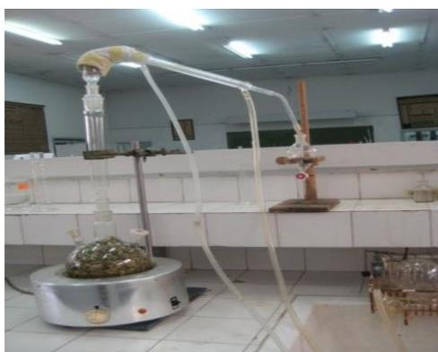
**Fig.05. Montage de l'hydrodistillation (Lab. Electrochimie-corrosion, EMP Alger, 2011)**
