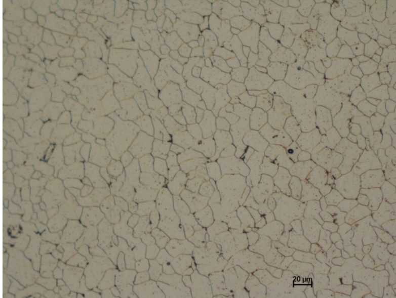
Figure V.8 : micrographie optique de l'extrémité d'éprouvette d'un acier (IF) 2 passes Route A à \phi = 115^\circ aperçu x200 recuit 3 heures 540°C.
