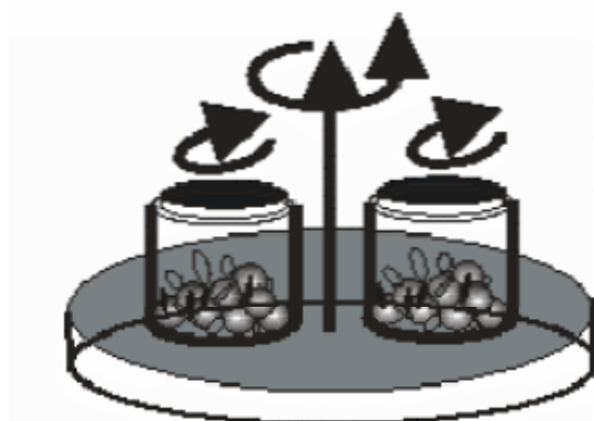
Figure I.11 : Schéma de principe du broyeur planétaire P7 [30]
