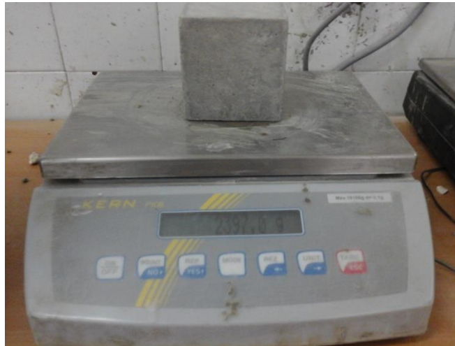
Figure III.1. Mesure de la perte de masse (LMGE Université d'Annaba).
