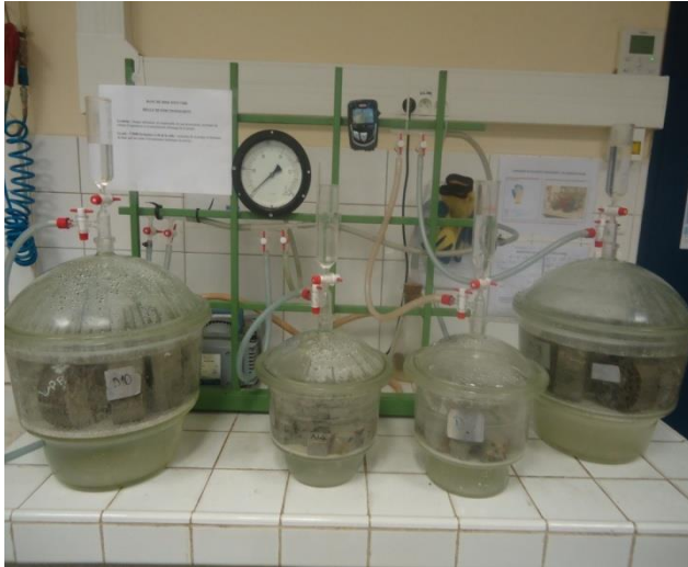
a- Dessiccateur à vide pour le dégazage des échantillons (Ø11xh5) cm
