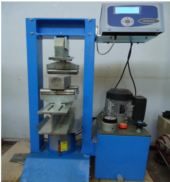
Figure III.4. Essai de traction par flexion (LMGE Université d'Annaba).
