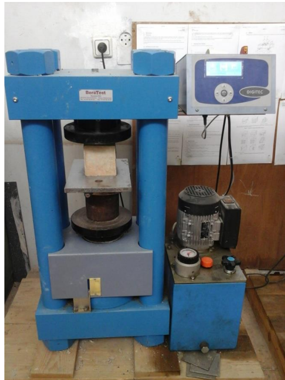
Figure III.3. Essai de compression (LMGE Université d'Annaba).
