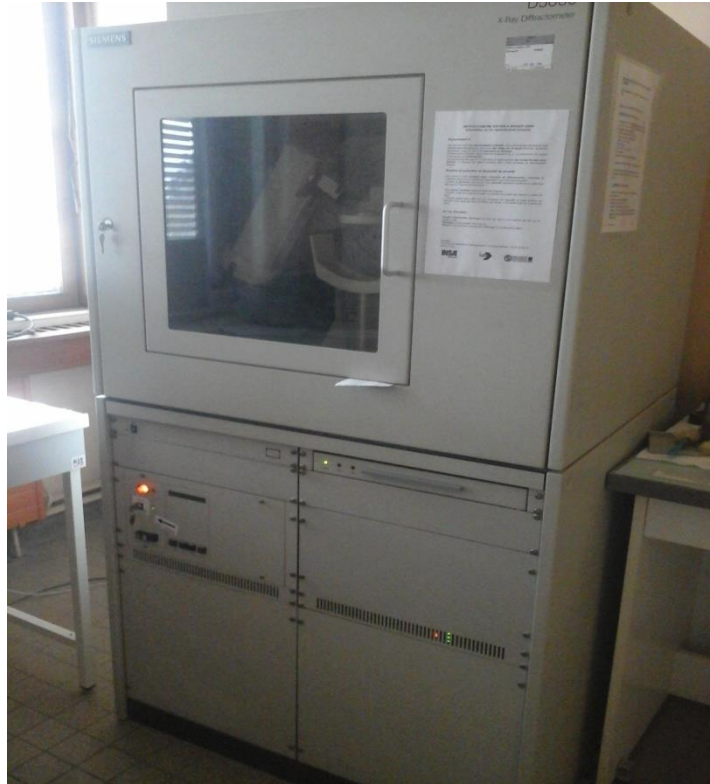
Figure IV.2. Dispositif utilisé pour l'analyse par Diffraction des Rayons X ( LMDC-INSA Toulouse ).
