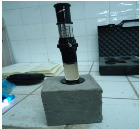
Figure III.6. Essai de mesure l'ouverture de fissure (LMGE Université d'Annaba).
