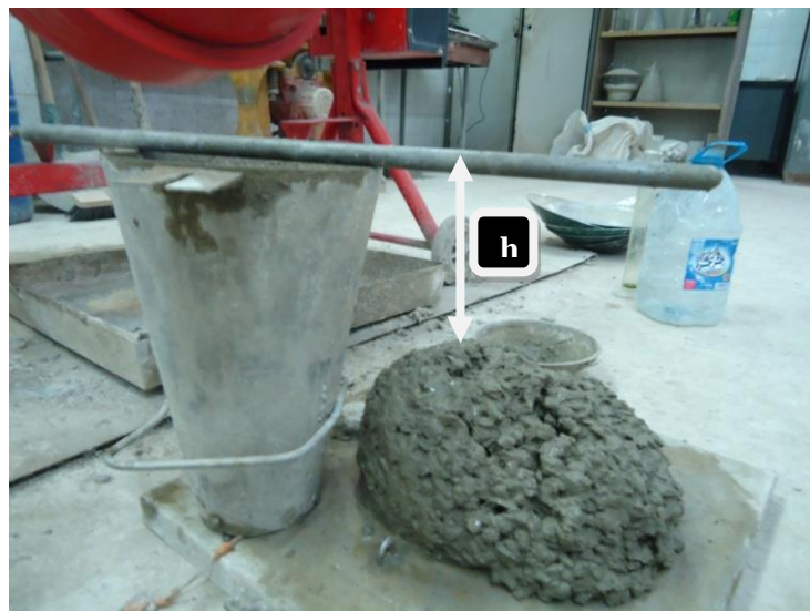
Figure II.12. Essai d'affaissement au cône d'Abrams (LMGE Université d'Annaba).
