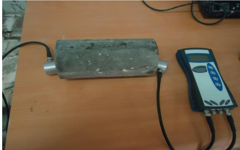
Figure III.5. La mesure de la vitesse de son (LMGE Université d'Annaba).
