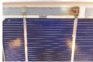
FIGURE 3.18 – Cellule affectée montre le défaut sur l’interconnexion entre cellules.
