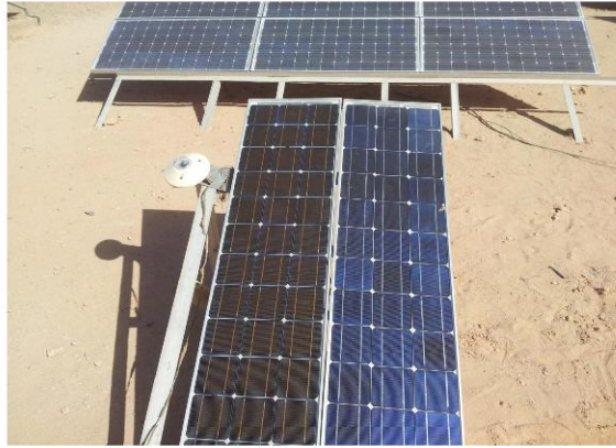
FIGURE 3.7 – Décoloration de l'encapsulant dans un module PV UDTS-50
