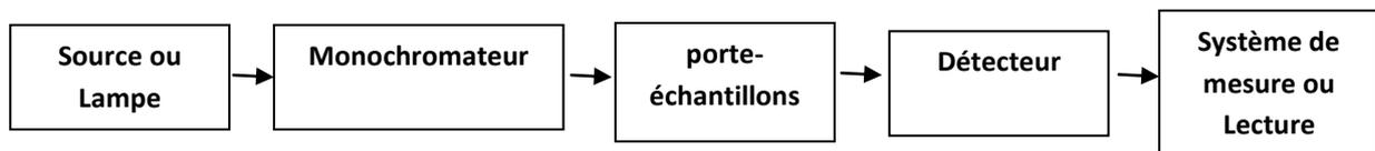
**Figure 26** : schéma simple d'un spectrophotomètre UV-VIS.
