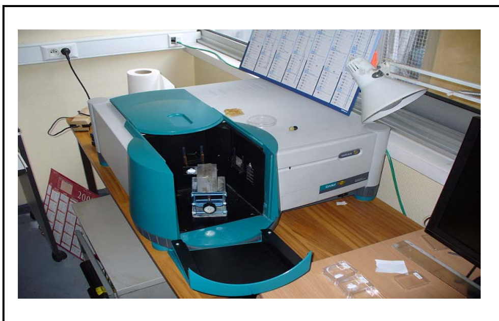
Figure III.12 : Photo du spectromètre de fluorescence CARY ECLIPSE
