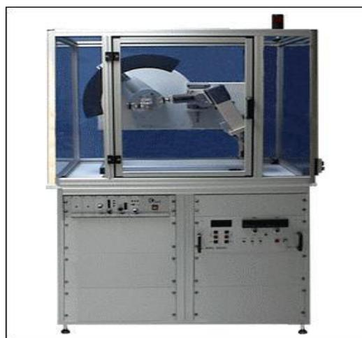
Fig. III-16. Diffractomètre Inel.
