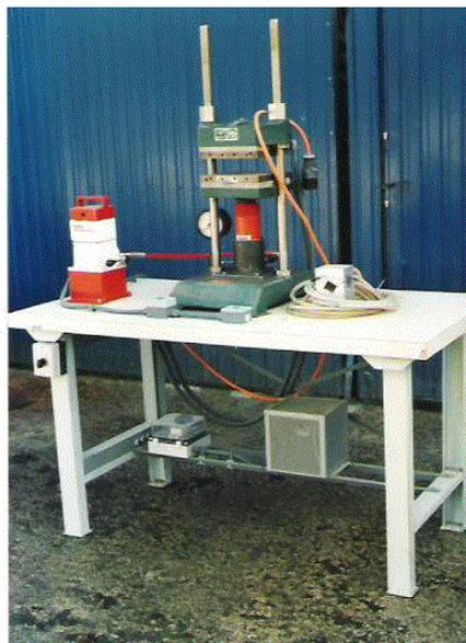
Fig. III-11. Presse hydraulique à matrice carrée
