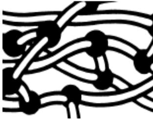
Figure I.12 : Structure d'un Thermodurcissable
