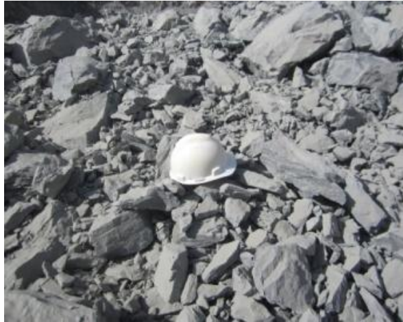
Fig. IV.12: Exemple des résultats visuels de la fragmentation (Amesmessa tir A 2015)
