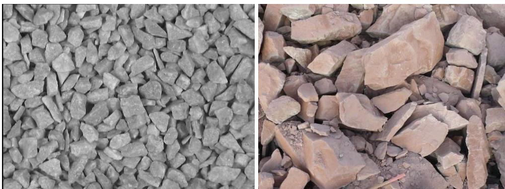
Fig. III.7: Bonnes pratiques d'échantillonnage (LxH = 768x576 pixels) (a) Granulat 4-6 (0,2 mm/pixel) (b) Tas abattu (4 mm/pixel)
