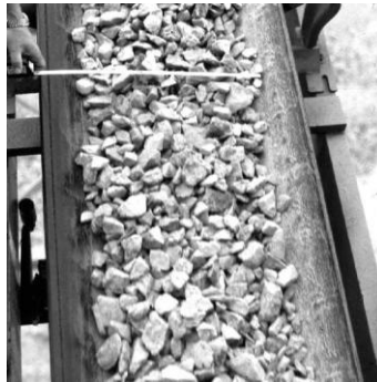
Figure III.4: Echantillonnage sur convoyeur à bande (Maerz, 1999 [90])
