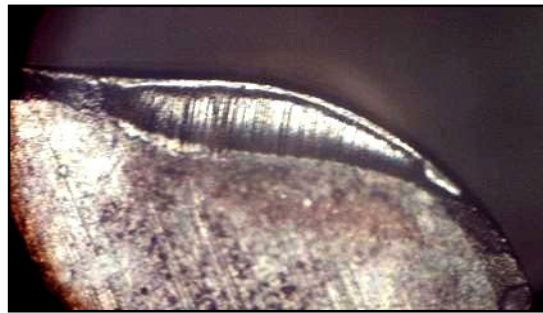
Figure I.29 : Usure en cratère de la surface d'attaque d'une plaquette en céramique mixte (CC650) [46].
