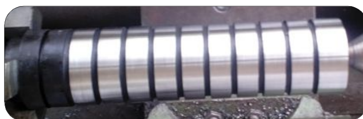
Figure III.2 : Éprouvette utilisée en tournage dur de l'acier 42CrMo4 trempé (48 HRC).
