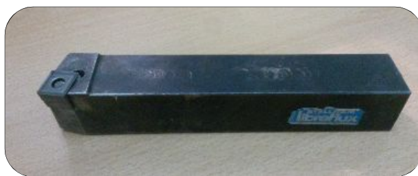
Figure 3.5 : Porte plaquette de référence (CSBNR 25-25 M12)
