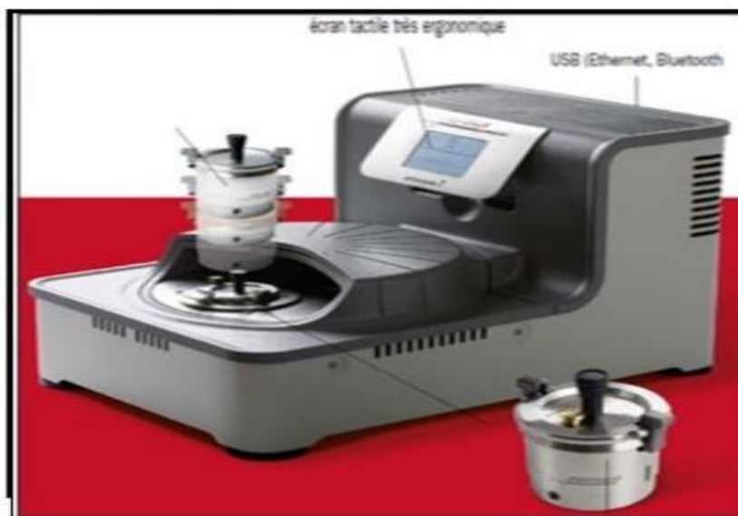
Figure II.2. Image d'un broyeur planétaire (Fritsch Pulverisette 7), P7.
