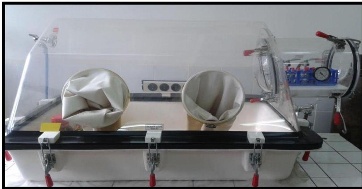
Figure II.1 : Exemple de boîte à gants (au laboratoire)
