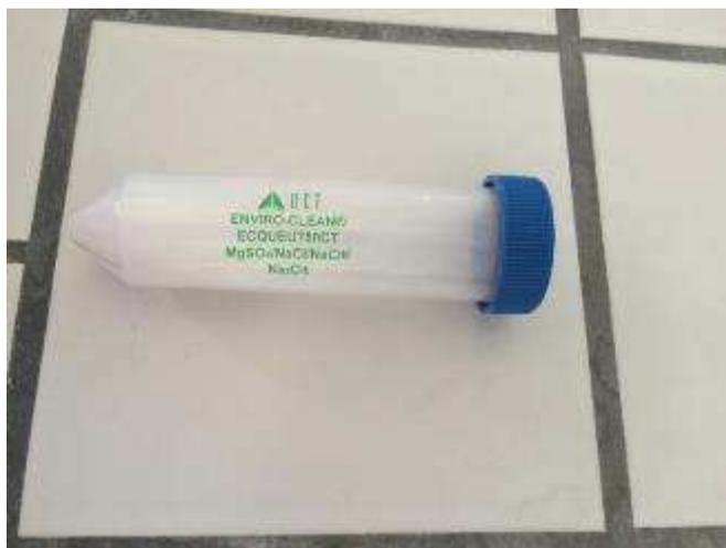
**Figure.20 :** Tube d'extraction contenant les sels.
