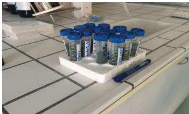
**Figure. 19 :** Mise des échantillons dans des tubes à centrifuger.
