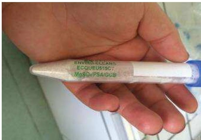
**Figure.21** : Tube de purification ( $MgSO_4$ /PSA/GCB)
