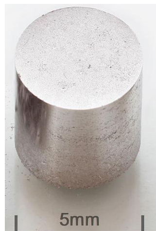
Figure II.2 : Poudre compacté sous forme cylindrique.
