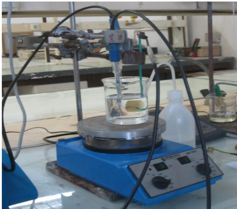
Figure II.11 : Photo présente les trois électrodes.
