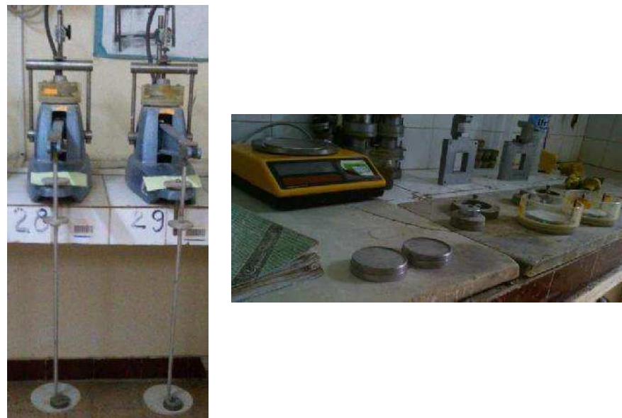
Fig.V.26. Essai oedométrique sur les échantillons du ciment (laboratoire de travaux publics- Est-Annaba).
