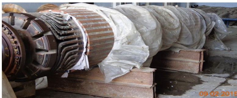
Fig (1.13) Rotor de l'alternateur GR4 centrale Annaba retiré de l'exploitation en février 2008 [34]
