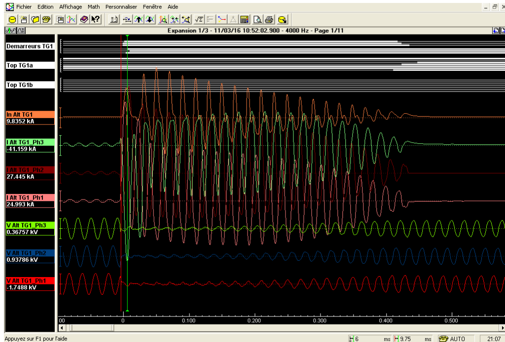
Fig (4.2) : Allures des tensions et des courants de phases suite au couplage des deux réseaux au niveau du poste 63 kV ANNABA
