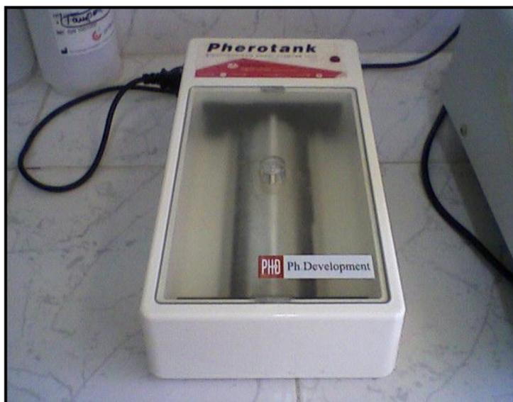
**Figure 11** Photo de l'Appareil de l'électrophorèse sur acétate de cellulose.
