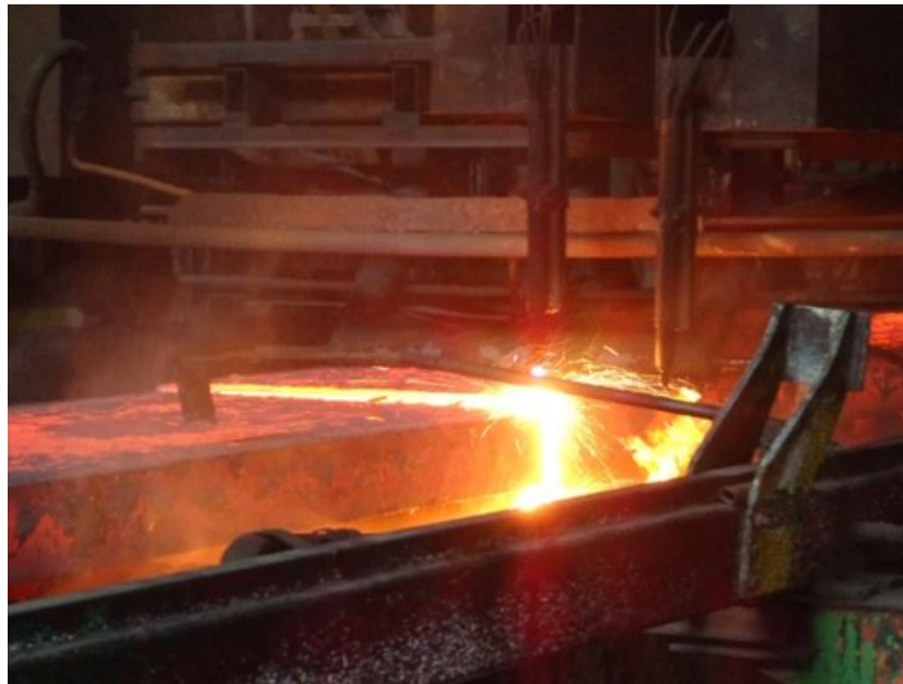
Figure 52 : La table d'oxycoupage.
