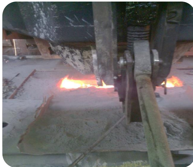
Figure 47 : Le tundish utilisé en Arcelor Mittal Annaba.
