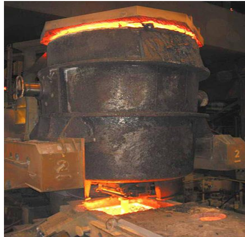
Figure 20 : Poche de coulée alimentant un répartiteur. [8]
