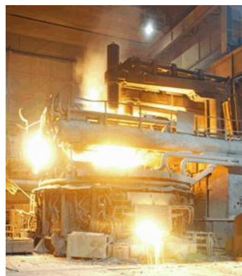
Figure 15 : Four électrique dans une aciérie.[11]
