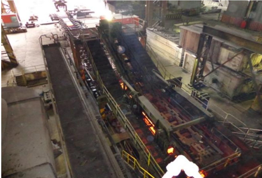
Figure 49 : Le mannequin de la machine coulée continué (Arcelor Mittal Annaba).
