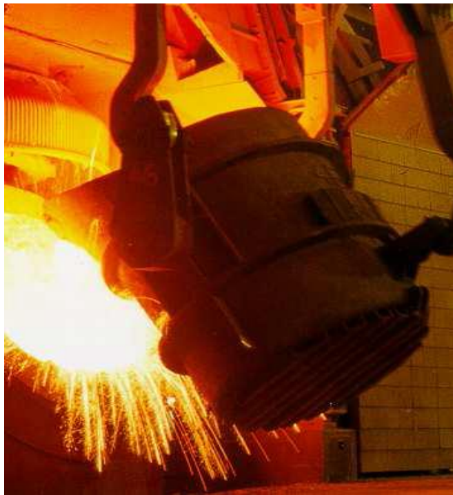
Figure 11 : Convertisseur à oxygène. [8]
