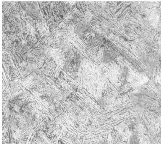
Figure 8 : Structure bainite supérieure acier 0,5%C – 0,8%Mn (Transformation isotherme à 500°C). [4]
