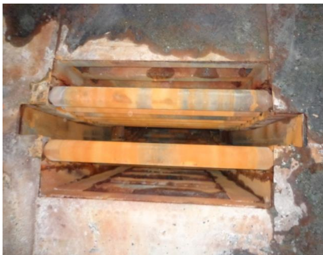
Figure 50 : Zone de refroidissement secondaire (Arcelor Mittal Annaba).
