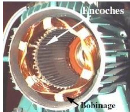
Figure (I.1). Photo du stator d'une machine asynchrone [13]
