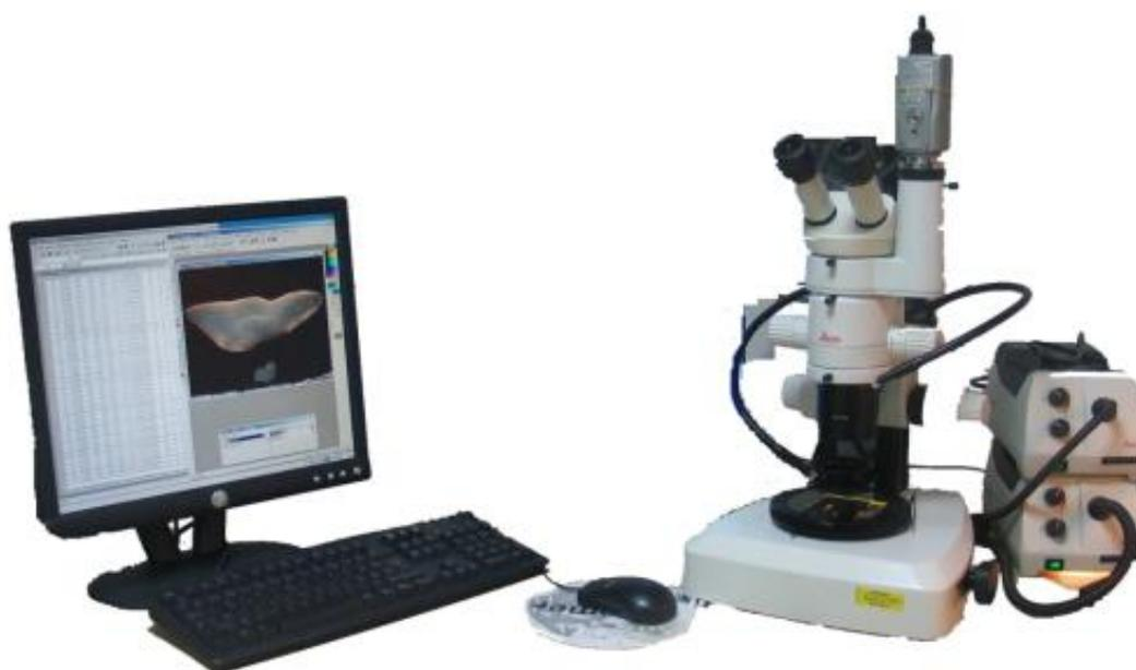
**Figure 12.** Dispositif d'observation utilisé pour l'analyse numérique de l'âge à partir du logiciel TNPC (Traitement Numérique des Pièces Calcifiées).
