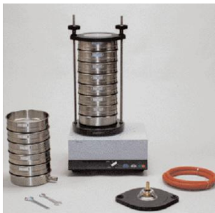
Figure 2.5 Ensemble agitateur et tamis normalisés pour l'analyse granulométrique.
