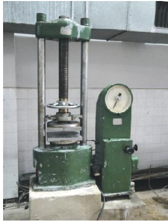
Figure 2.3 Machine d'essai de compression (Presse hydraulique LGC. UBMA)
