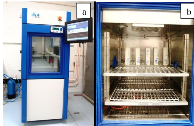
Figure 2.31 a, Photo de la chambre climatique BiA. b, photo des éprouvettes à l'intérieur de la chambre climatique.
