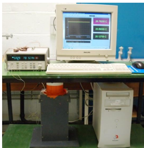
Figure 2.21 Photo Dispositif expérimental pour l'essai d'inhibition
