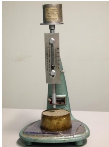
Figure 2.26 Photo de l'appareil Vicat pour l'essai de prise
