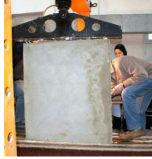
Figure 2.12 Mise en place du Muret et vérification des jauges de déformation sur un muret à briques de 8 trous enduit par mortier de ciment renforcé de nappe de fibre de jute.
