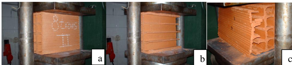
Figure 2.4 Essais de compression, a: centrage des éprouvettes, b: rupture des briques à 8 trous, c: rupture des briques à 12 trous.
