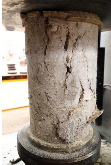
Figure 4.34 Photo de l'éprouvette en composite JFC2 rompue en compression simple.
