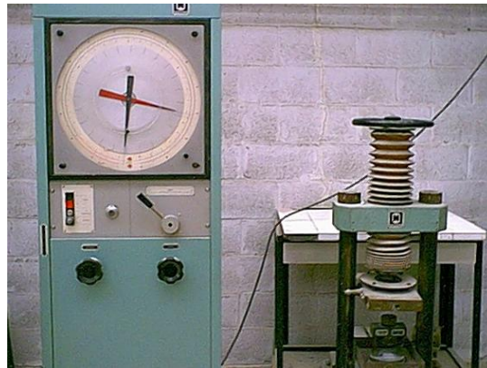
Figure 2.29 : Photo de la presse pour essai de compression
