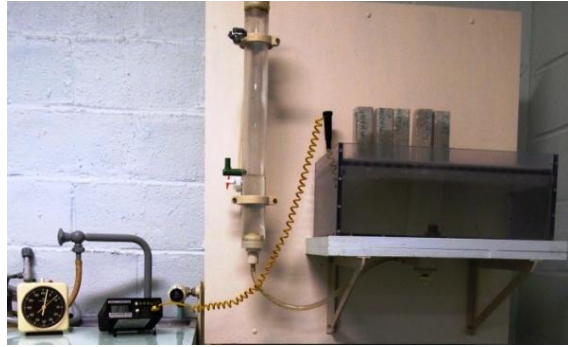
Figure 2.34 : Montage expérimental pour l'essai d'imbibition capillaire
