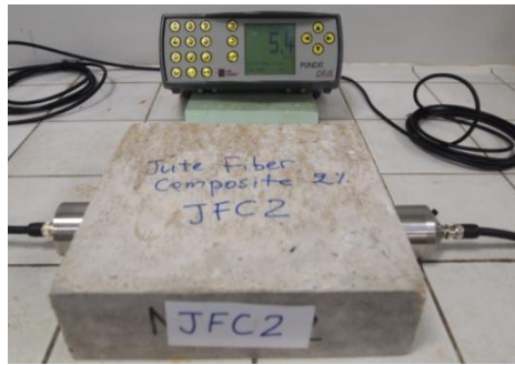
Figure 2.27 Photo de l'appareil Ultrasonic Tester PUNDIT 7
