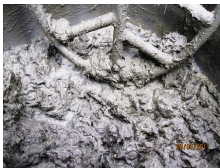
Figure 4.3 Composite fibré (JFC2) à l'état frais pendant le malaxage.
