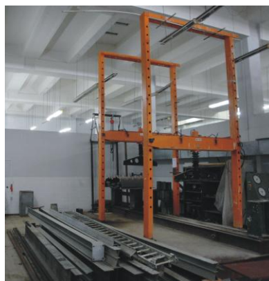
Figure 2.11 Machine utilisée: portique d'essai d'éléments de structure en grandeur réelle.
