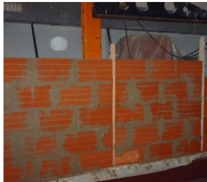
Figure 2.9 Photo des murets sans enduit.
