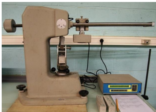
Figure 2.28 Photo de la presse pour essai de flexion
