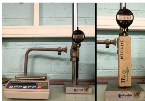
Figure 2.32 Photo du rétractomètre et de la balance utilisés
