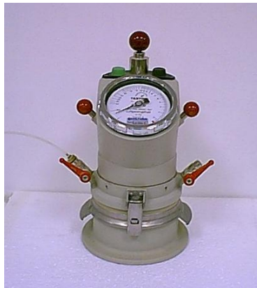
Figure 2.25 Photo de l'aéromètre à mortier
