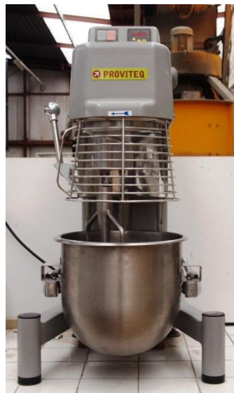
Figure2.24 Malaxeur ayant servi à l'élaboration des échantillons.
