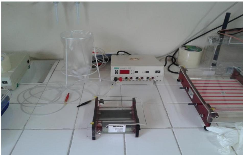
Figure 20: Matériel pour l'Electrophorèse sur gel d'agarose
