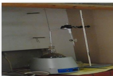
Figure 8. Montage de l'appareil d'hydrodistillation (Labo. de botanique médicale UBMA. 2012)
