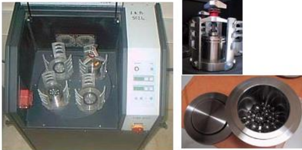
Figure II.4 : Broyeur planétaire, de marque commerciale Retsch PM 400.
