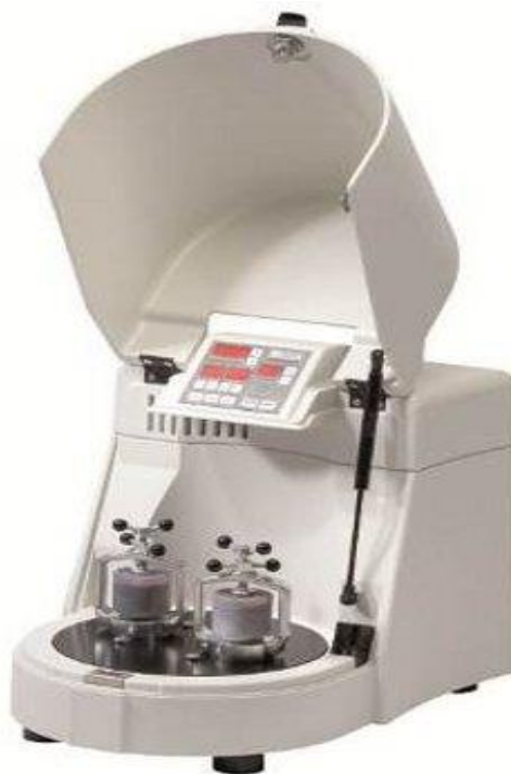
Figure III.1 : Broyeur planétaire "pulvérisette P7".
