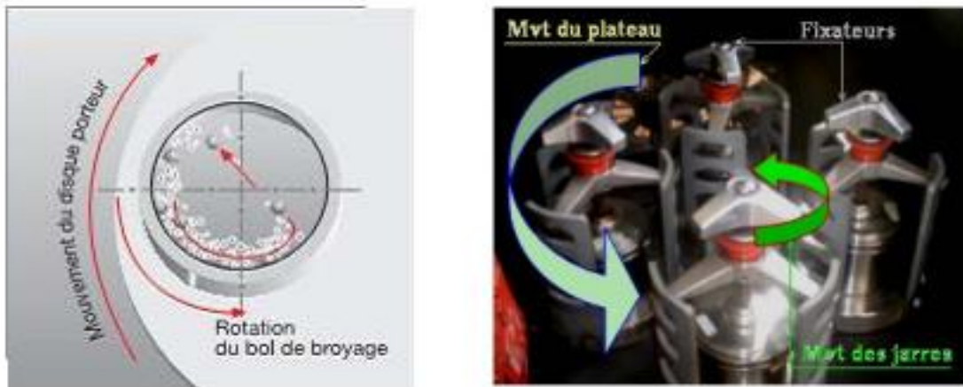
Figure II.3 : Mouvement des billes à l'intérieur des jarres et rotation du plateau.
