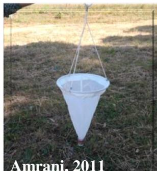
**Figure 18** : photographie d'un filet à plancton.
