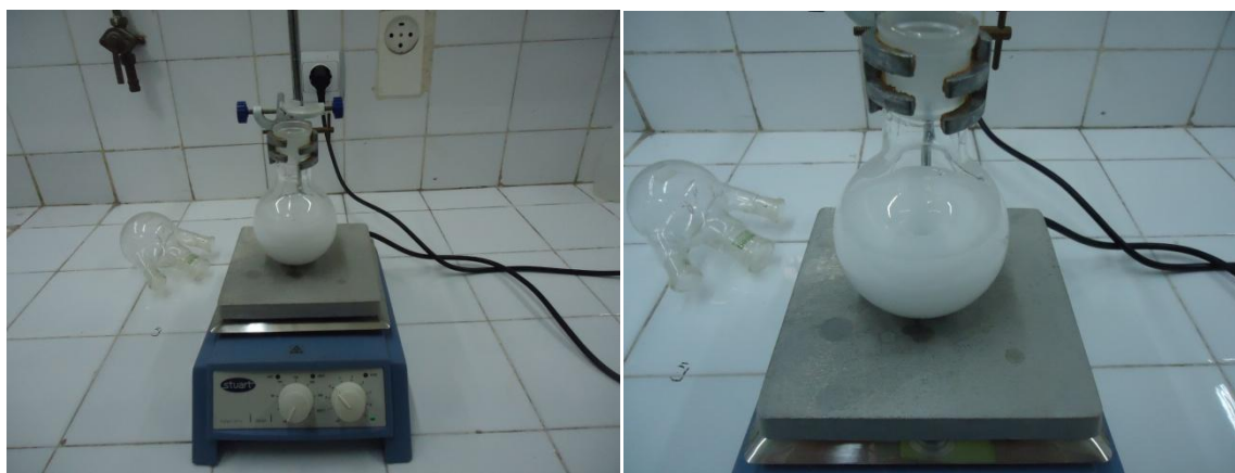
Fig. V.11. Mélange contenant 200mL d'acide citrique et 4g de catalyseur ZnO/Al 2 O 3
