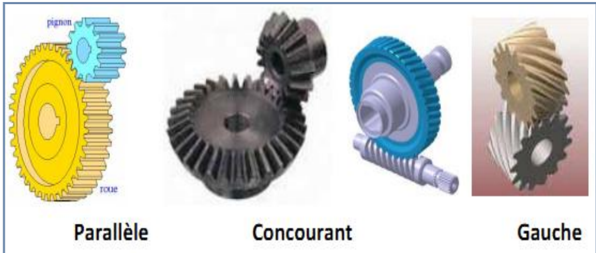
Figure 1.14 Différents types d'engrenage [72]
