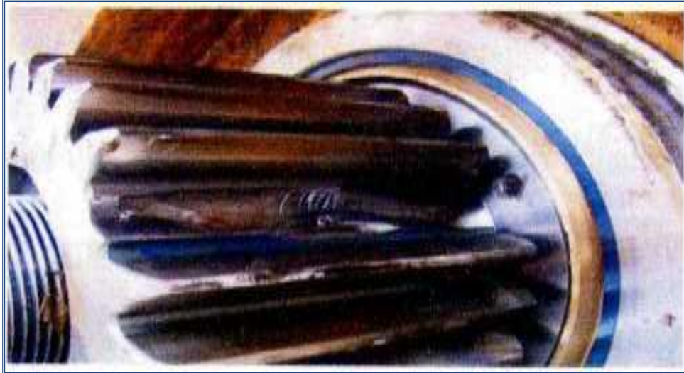
Figure 1.15 Défauts réels d'engrenage localisé [72]
