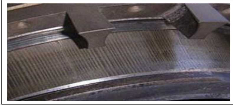
Figure 1.17 Cannelure sur un roulement.
