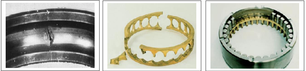
Figure 1.19 Rupture des éléments d'un roulement.
