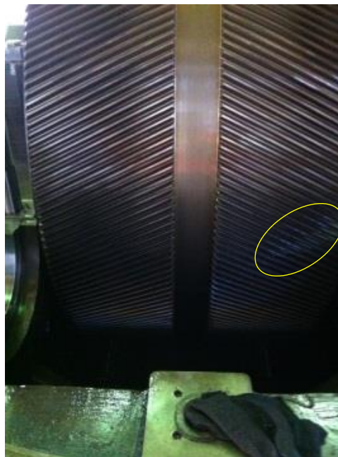
Photo 4.2 Usure des dents d'engrenage.
