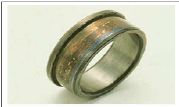
Figure 1.18 Grippage d'une bague.
