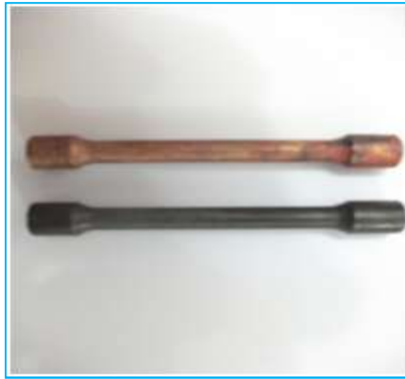
Figure II.24 : exemple d'éprouvettes de fer et de cuivre après recuit
