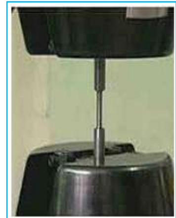
c) Eprouvette installée entre les mors de machine de traction
