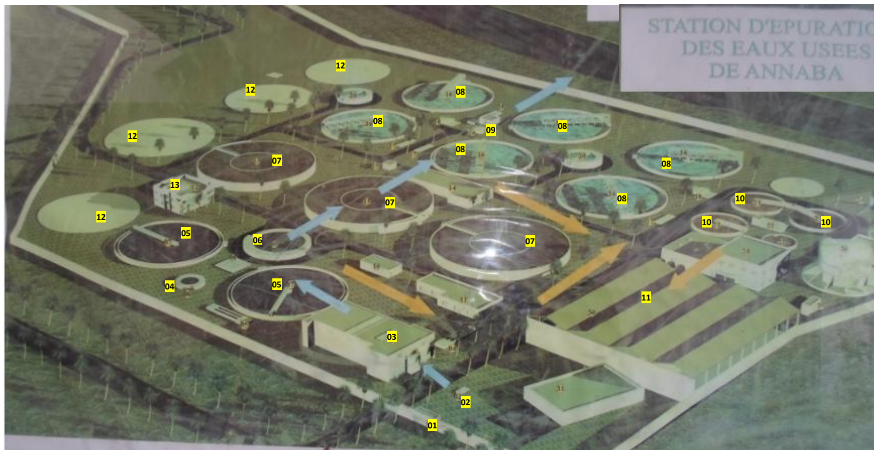
Figure 5. Photographie de la maquette montrant les différentes files du traitement des eaux usées et des boues dans la STEP d'Annaba (ONA Annaba). 01 Débitmètre (compteur des eaux), 02 l'entrée des eaux usées vers le pré traitement, 03 unité du pré traitement, 04 bassin répartiteur, 05 bassins de décantation, 06 bassin de relevage, 07 bassins de traitement biologique, 08 bassins clarificateurs, 09 sortie des eaux, 10 bassins de déshydratation de boues, 11 unité de traitement de boues, 12 lits de séchage de boue (non exploités), 13 administration et laboratoire, 14 gazomètre (non exploité). → Cheminement du traitement de l'eau → cheminement du traitement de la boue.
