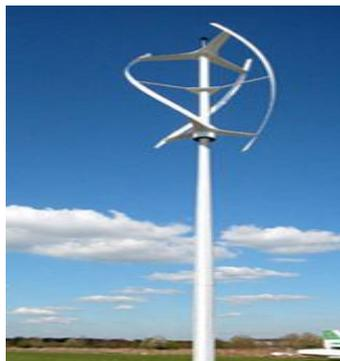
**Fig. 1.9** Eoliennes à axe vertical [18]
