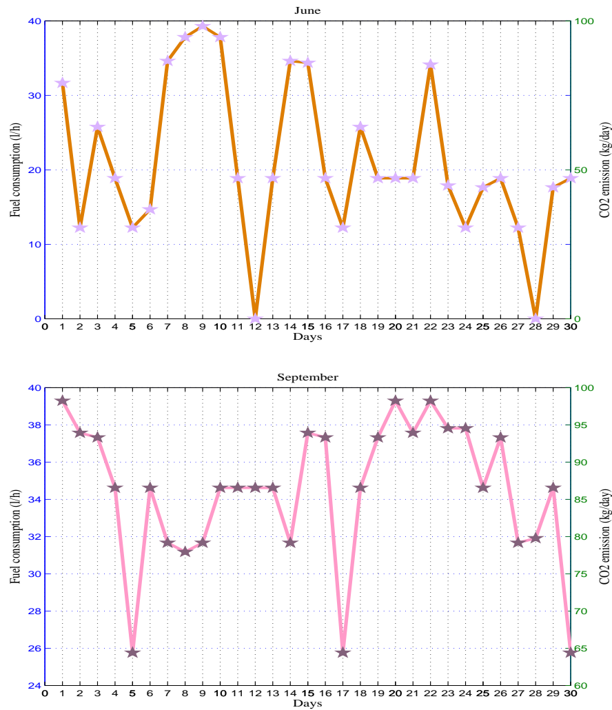
Figure 4.8 – Analyse de l’effet de la consommation du carburant et son incidence sur l’émission de CO_2
