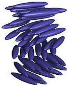
Fig. I.11 : Positionnement et orientation des molécules dans une phase cholestérique.
