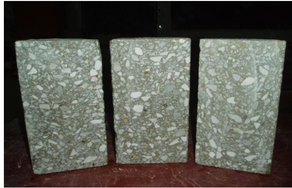
Figure 4.23. Observation de la répartition des granulats des BAP LC (30, 45 et 60%), présentés de gauche à droite
