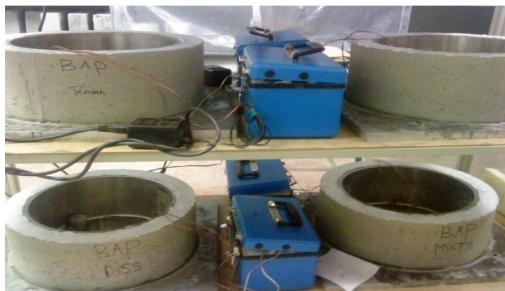
Figure 2.27. Connexion des jauges aux appareils de mesure de déformation
