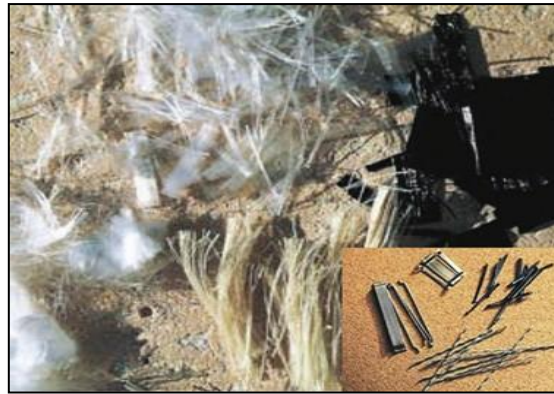
Figure 1.21. Exemples des fibres d'acier, de carbone et de polypropylène
