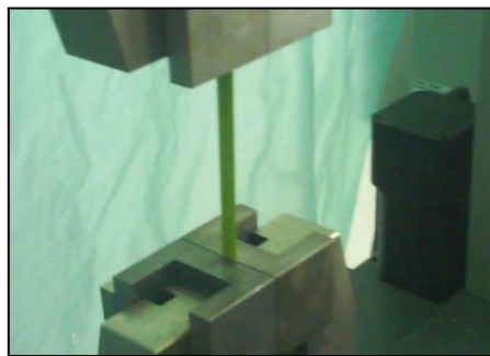
Figure 2.13. Essai de traction directe sur la fibre de diss (Laboratoire de Génie Civil - Annaba)
