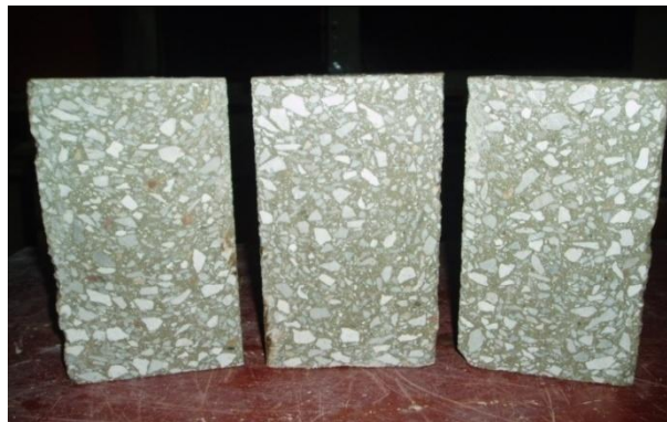
Figure 4.22. Observation de la répartition des granulats des BAPFC (30, 45 et 60%), présentés de gauche à droite
