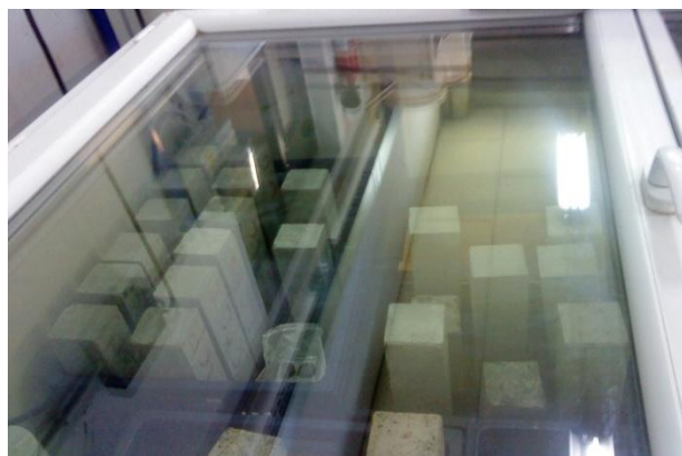
Figure 2.30. Enceinte de carbonatation
