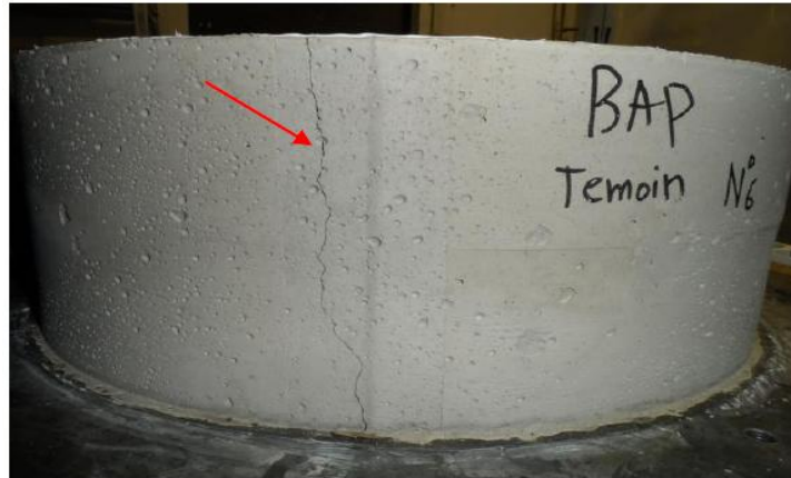
Figure 5.36. Fissuration de l'éprouvette annulaire
