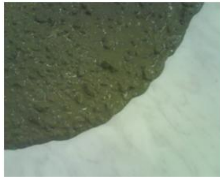
Figure 2.16. Etalement d'un BAP sans ressuage
