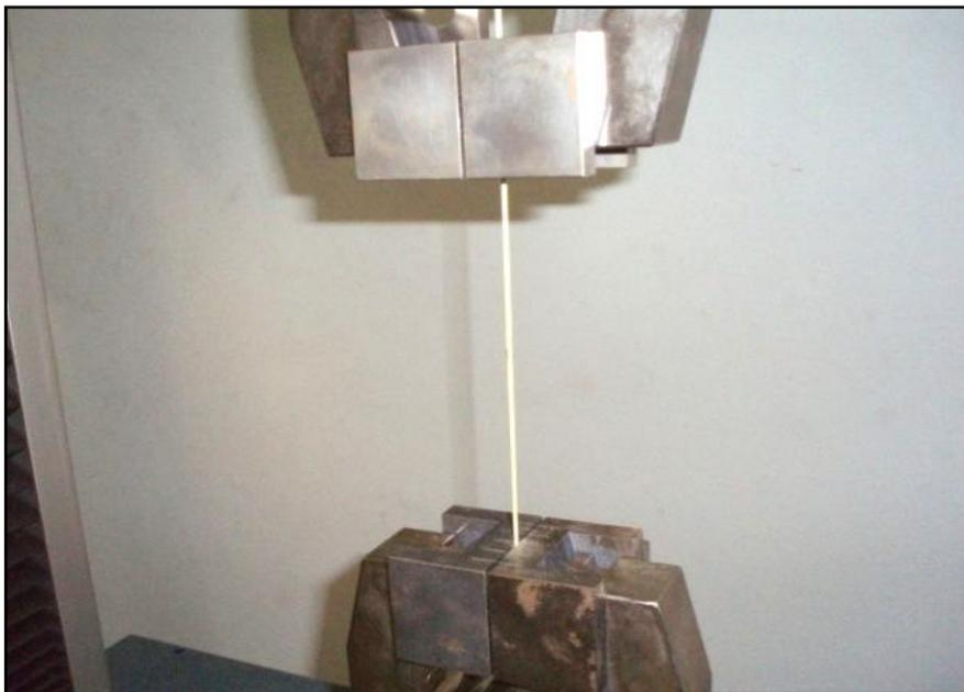
*Figure II.20 : Essai de traction sur une fibre de diss*
