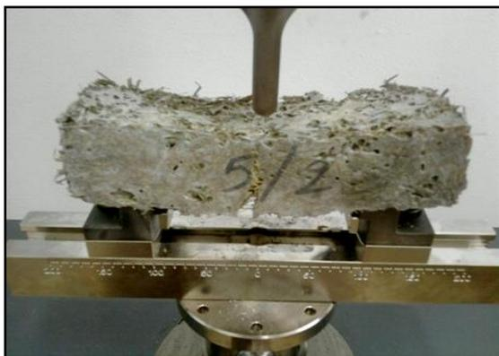
*Figure II.27 : Essai de traction par flexion*
