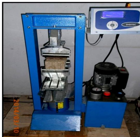
Figure IV.3 : Essai de flexion de trois points sur une brique de diss
