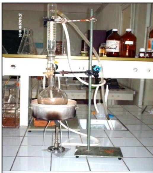
*Figure II.10 : Délipidation d'échantillon par le system (ballon+réfrigérant à reflux)*
