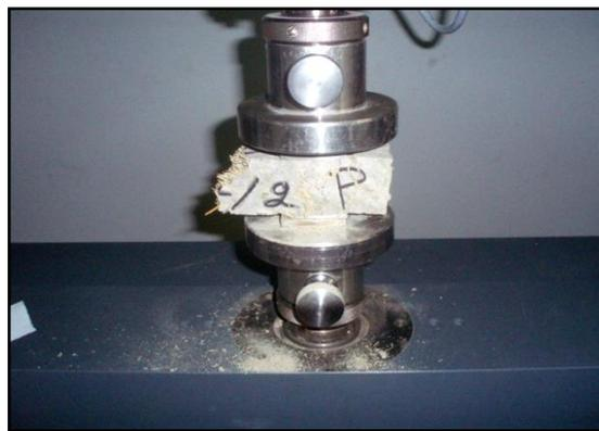
*Figure II.28 : Essai de compression*
