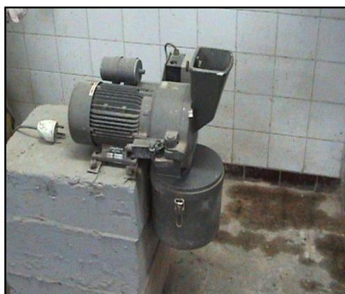
*Figure II.3 : Broyeur électrique de type Retsch*
