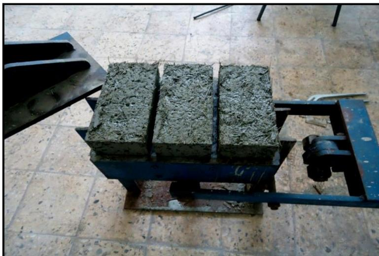
*Figure IV.1 : Briques à base de fibres de Diss de type  $(70 \times 110 \times 220)$  mm<sup>3</sup>*
