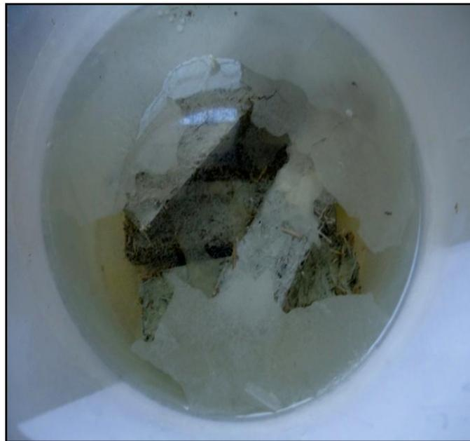
*Figure V.6 : Vieillesse alcaline des composites à base de fibres de diss*
