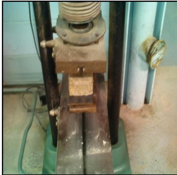
*Figure IV.4 : Essai de compression sur une brique de diss*
