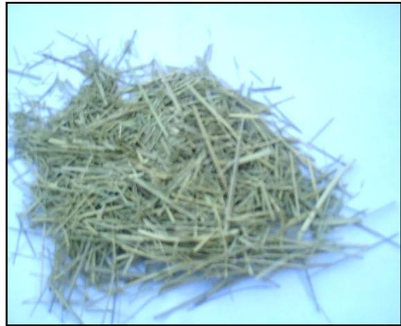
**Figure II.6 :** Fibres de diss traitées et séchées
