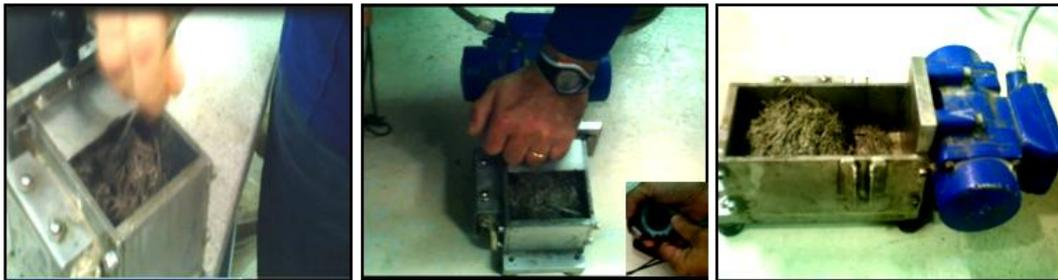
*Figure II.24 : Essai de maniabilité du composite de diss (IUT d'Amiens, France)*
