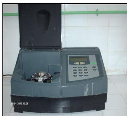
*Figure II.17 : Spectrophotomètre*
