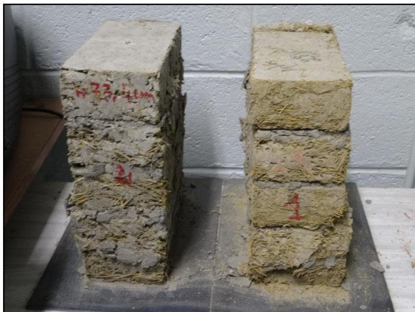
Figure IV.9 : Rupture des assemblages de briques à base de fibres de diss
