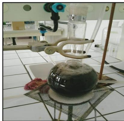
Figure II.13 : Hydrolyse par reflux
