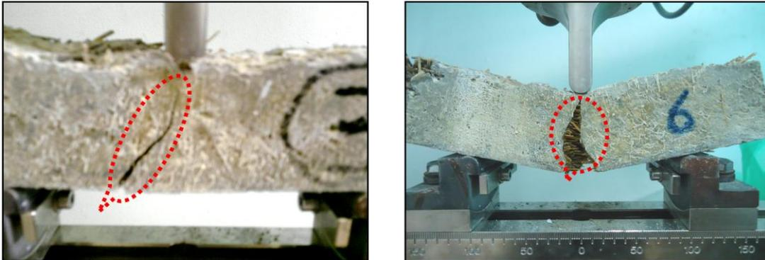
*Figure V.9 : Essai de flexion après chaque vieillissement alcalin*
