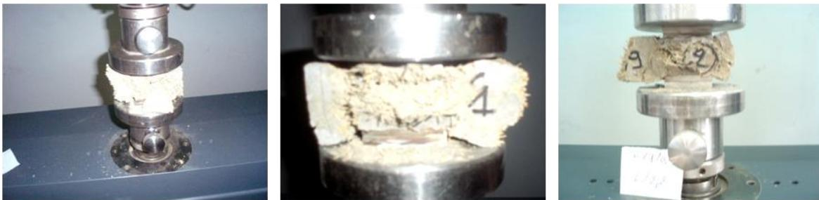
*Figure III.8 : Essai de compression sur des composites avec différents volumes*
