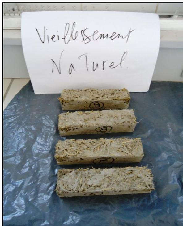
*Figure V.1 : Vieillissement naturel des éprouvettes en fibres de diss*
