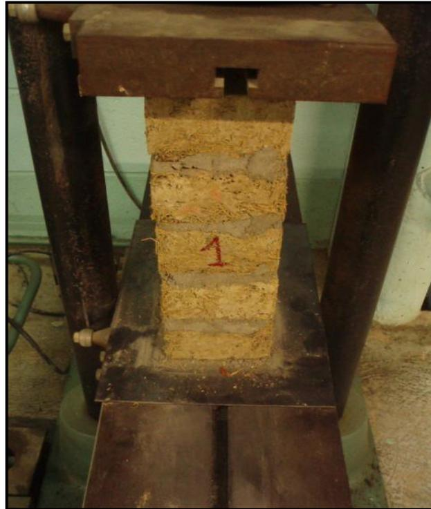
Figure IV.7 : Essai de compression sur un prisme de briques de diss
