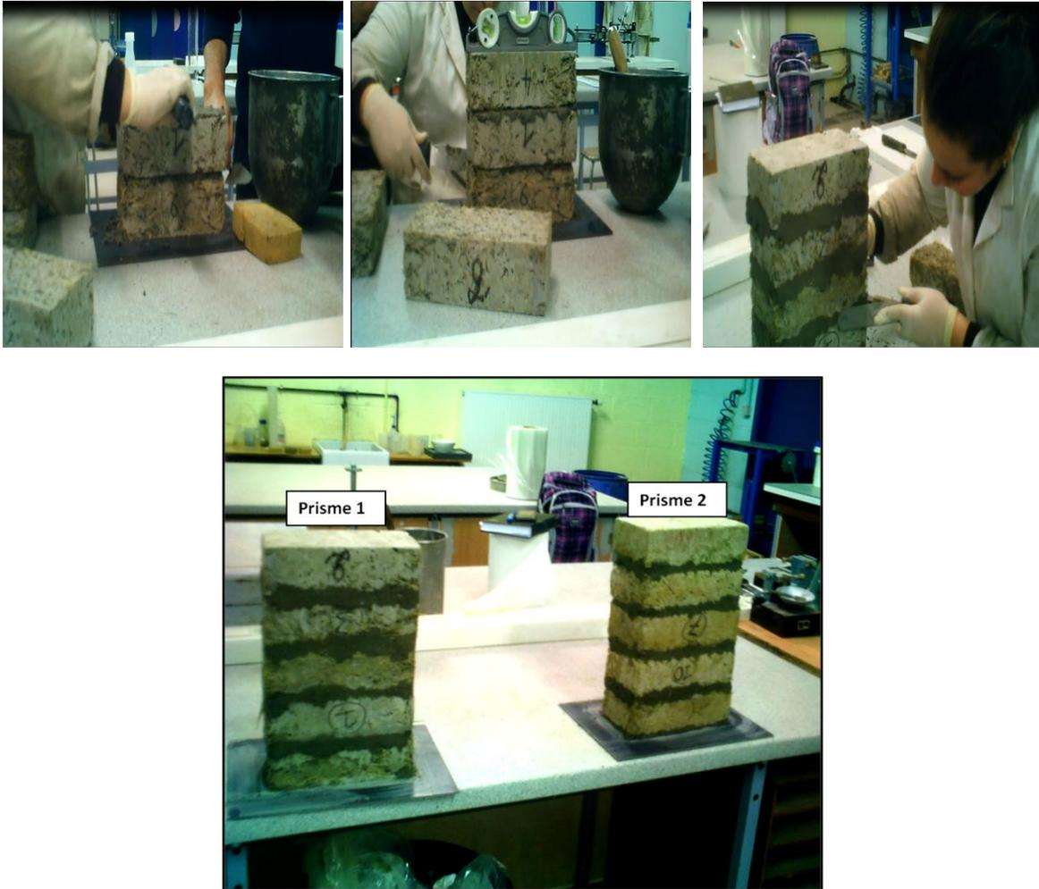
*Figure IV.6 : Prismes confectionnés avec des briques de fibres diss*
