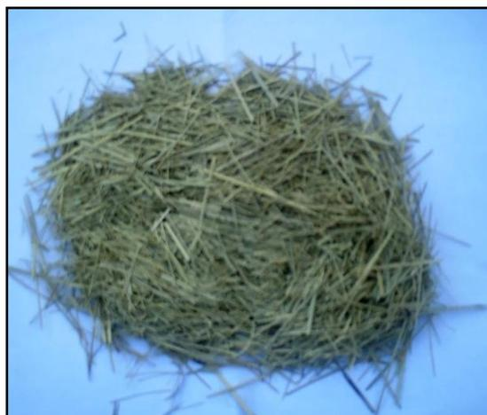
**Figure II.7** : Traitement de fibres de diss avec l'eau du robinet
