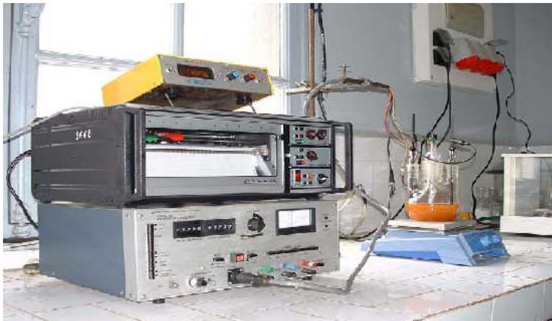
Figure III.11 : Schéma D'installation Du Système De Mesure Electrochimique Nécessaire Au Tracé Des Courbes De Polarisation. [Laboratoire de métallurgie, Annaba].
