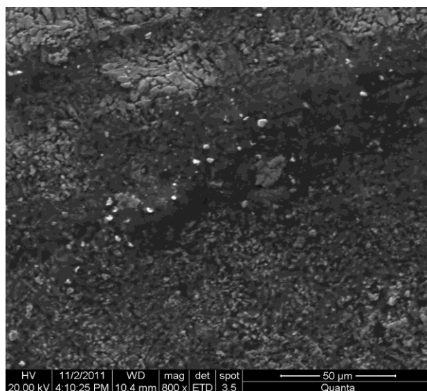
Figure.III.10. (a,b,c,d,e): micrographie par MEB montrant l'usure des surfaces des échantillon s A et B à l'état nétrocarburé.
