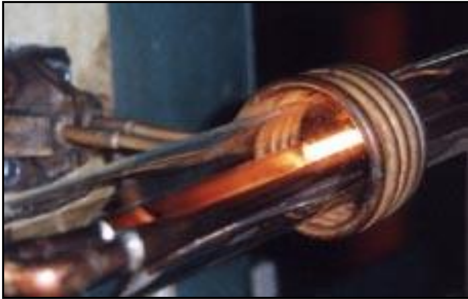
Figure.I.3. Fusion de zone sur nacelles de cuivre refroidies sous atmosphère contrôlée
