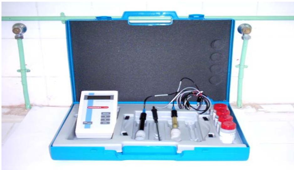
Figure6: Schéma d'un multi paramètre (CONSORT 535).
