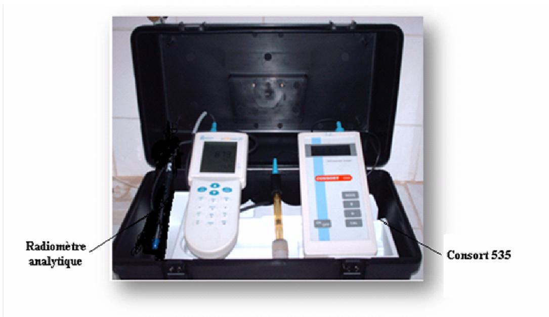
**Figure 8:** Photographie des deux multiparamètres utilisés.
