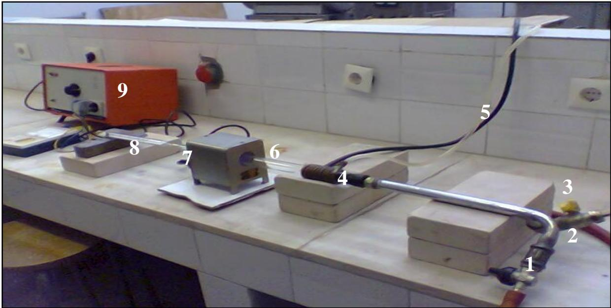
*Figure III-4. Photographie du montage expérimental d'oxydation des couches de zinc*
