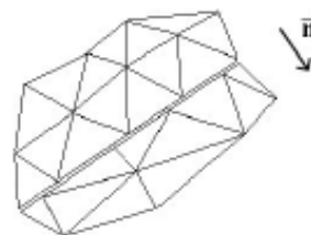
Fig.3.4 b Maillage incompatible sur l'interface
