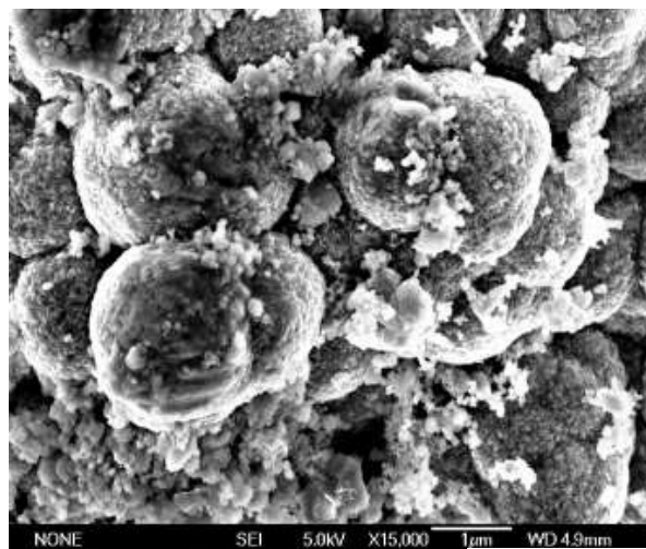
Figure III-26 : Photo FEMEB de MgB_2 élaboré par SHS amorcé sans TiC.
