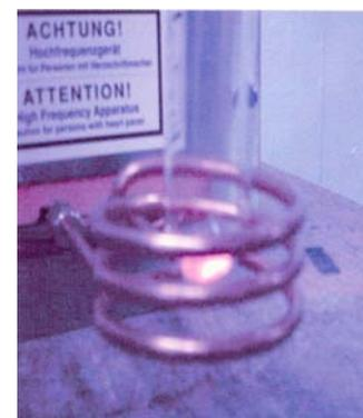
Figure III-2 Générateur Haute fréquence sous induction électromagnétique et alliage en fusion.
