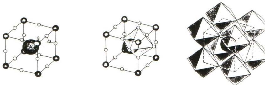
L'exemple de  $\text{YBa}_2\text{Cu}_3\text{O}_7$  : empilement de trois mailles pérovskite élémentaires, avec un défaut de deux atomes d'oxygène ( $3A = (\text{Y} + 2\text{Ba})$ ,  $3B = 3\text{Cu}$ ,  $9\text{O} = 9\text{O} - 2$  défauts). On retrouve donc systématiquement dans tous les nouveaux supraconducteurs, le plan  $\text{Cu-O}_2$ , à l'intérieur desquels la supraconductivité semble favorisée.
