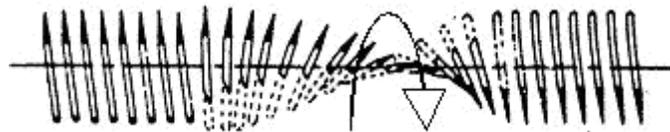
**Fig. 1.7 :** Répartition des spins dans le cas d'une paroi de Bloch
