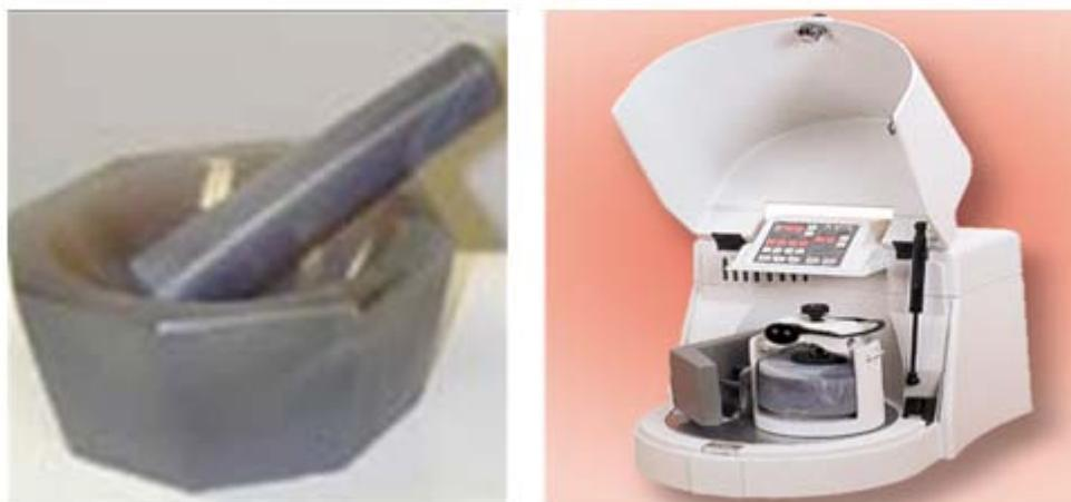
**Fig. III. 3 :** bol en agate (gauche) ; Pulvérisette Fritsch 6 (droite).
